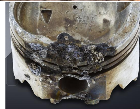
Pistón con daño por LSPI (16000 Km)
